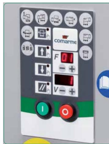
**Fr\_** Tableau de commande à microprocesseur avec panneau numérique pour la sélection du cycle de banderolage et pour le réglage des paramètres (avec possibilité de personnaliser le cycle de banderolage).
